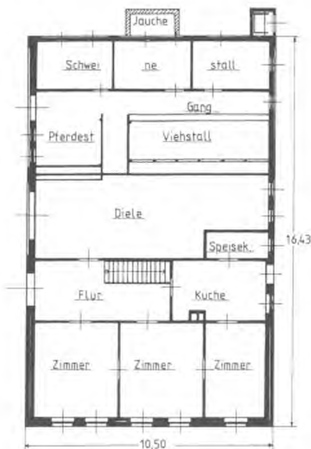
Bild 9.58: Grundriß des 1910 von C. Harms errichteten Hofes mit Stallungen für Pferde, Rinder und Schweine.
